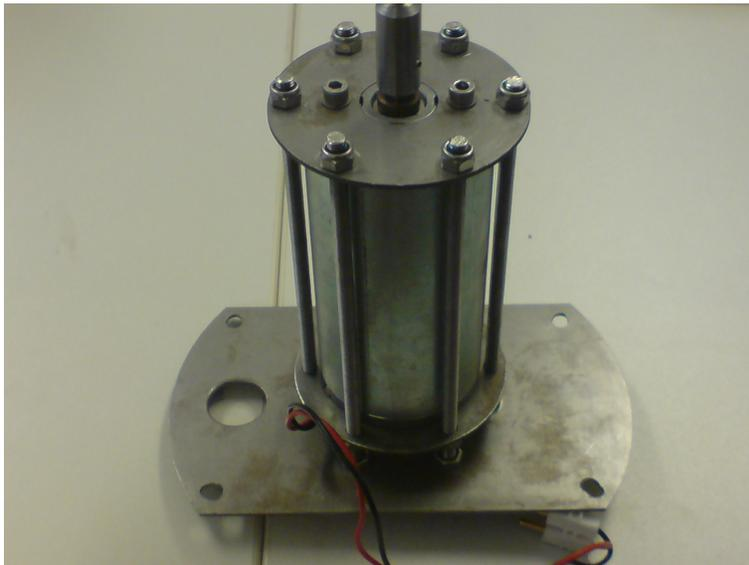
Abbildung 2.26: Bild Neue Motorhalterung mit Motor
