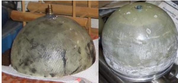
Abbildung 2.5: Buggussform und fertiges Teil
